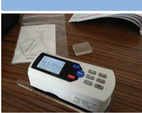
Resim 8: Kalite Kontrol Laboratuvarı için satın alınacak "yüzey pürüzlülüğü ölçüm cihazı" örneği
